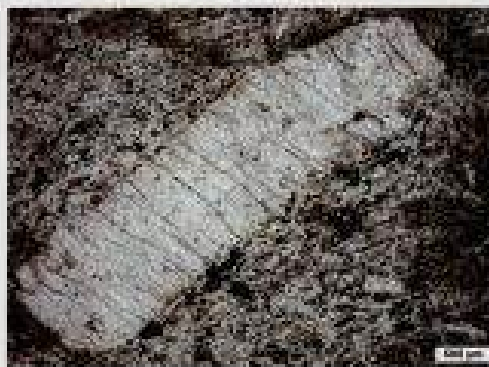
Dünnschliffaufnahmen des Phonoliths: Zerbrochener Alkalifeldspat-Einsprengling in fließeregelter Grundmasse aus Alkalifeldspäten mit Erzkomponente und Alkalipyroxenen (X bunt) in Zwickeln.
